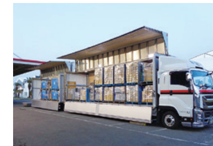
積載効率向上のために導入したダブル連結トラック
