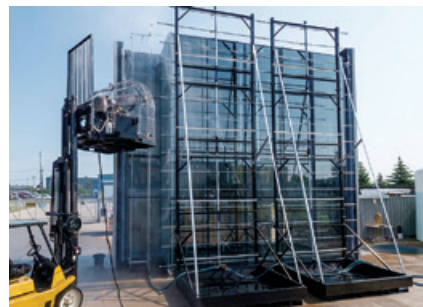
エリーAP社、ユニットカーテンウォール性能検証の様子
