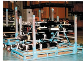
<邸別梱包レス> 一棟ごとにサッシをパレットにまとめて発送しています。
