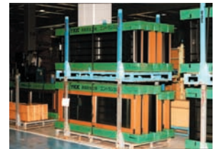
<通い梱包材> ハウスメーカー向けに緩衝材を通い梱包材とし、パレット発送によるノー梱包化を実施しています。
