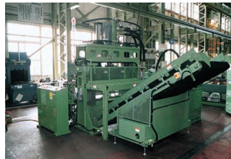
アルミ材屑処理装置 <効果> 屑の減容化(かさ比重約1.5倍) 屑処理作業の省力化 屑の搬送回数の削減 屑の在庫スペースの削減 使用バケツ数量の削減
